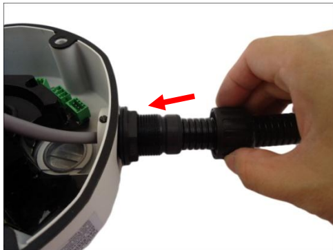
Using Flex Conduit
